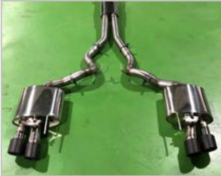
**4-Rohr Abgasanlage ab Kat**
